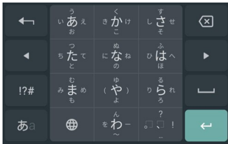
図 2 フリックキーボードの例。「り」と入力する場合、「ら」行のキーにタッチダウンし、左方向にフリックする。
