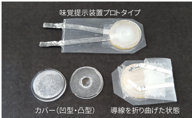
図 1 圧電素子を利用した味覚提示装置プロトタイプ (上) とカバー (左下), 導線を折り曲げた状態 (右下) .
