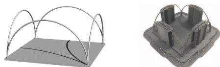
図 1. FDM 方式 3D プリンタで出力困難な例(左)と造形結果(右). 造形結果は各部に断線や線の乱れが見られる.
