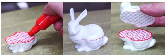
図7 断面への着色による接着具合の変更。せん断方向に力を加えることで容易に分割可能。
