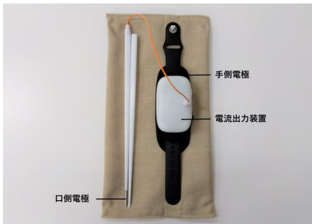
図1 実験に用いた電気刺激提示デバイス
