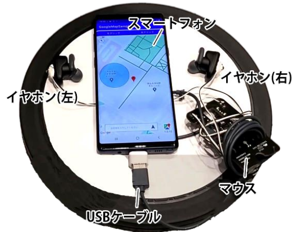
図 4 電子コンパスの確認インタフェース。右イヤホンと左イヤホンにスイッチを取り付けこれをマウスと接続することで、各イヤホンのタップ情報を得ている。
