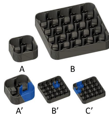
図 11 2×2の乾電池ボックスと 5×5の乾電池ボックスを入力したときに生成される 3Dモデル (A', B', C'は青色の 3Dモデルを生成)
