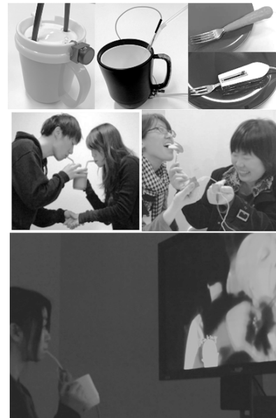
図 4 電気味覚を応用した味情報提示 (上：電気味覚提示装置 [28] 中：複数人での活用の様子 [29] 下：複合感覚提示時の味情報提示 [31])
