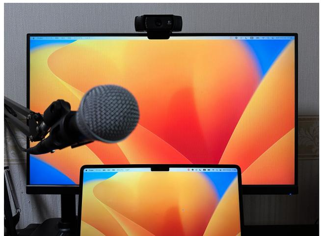
図1 ディスプレイの一部が遮蔽される例。カメラは上部中央、マイクは左下、ノートパソコンは下部を遮蔽している。
