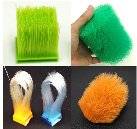
図 7. 高密度な毛構造の造形手法をデザインシステムとして実装. さまざまな形状に応用した例.
