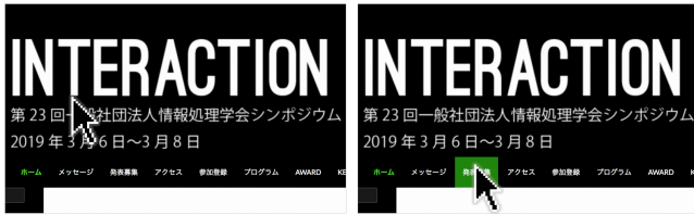
図 1 ナビゲーションバーの例。アイテムにカーソルがのったとき、アイテムの背景がハイライトされる。背景がハイライトされるまで Motor Width の正確な大きさを把握できないが、左右のアイテムの並びからおおよそその Motor Width を推測できる。このとき、アイテムのラベルが Visual Width である。
