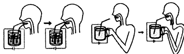
図1 飲料用付加装置の回路構成(左:両極用 右:一極用)
