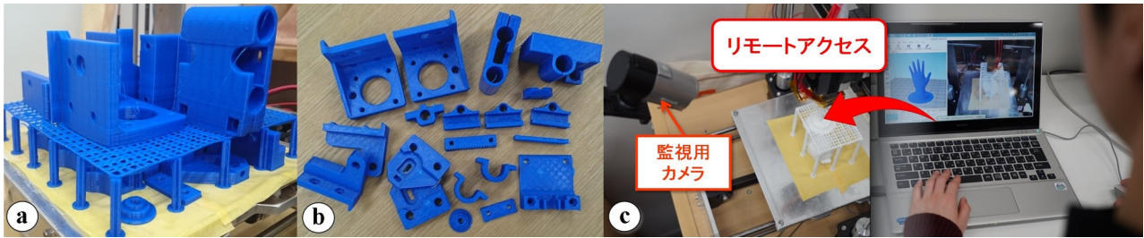
図2 提案手法の活用例。(a) 20個の自作3Dプリンタパーツを同時造形した例。(b) プラットフォームから取り除いた様子。(c) リモートアクセスで3Dプリンタを制御し、プラットフォーム層を活用して造形を行った例。
