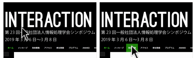
図 1 ナビゲーションバーの例。アイテムにカーソルがのったとき、アイテムの背景がハイライトされる。背景がハイライトされるまで Motor Width の正確な大きさを把握できないが、左右のアイテムの並びからおおよそその Motor Width を推測できる。
